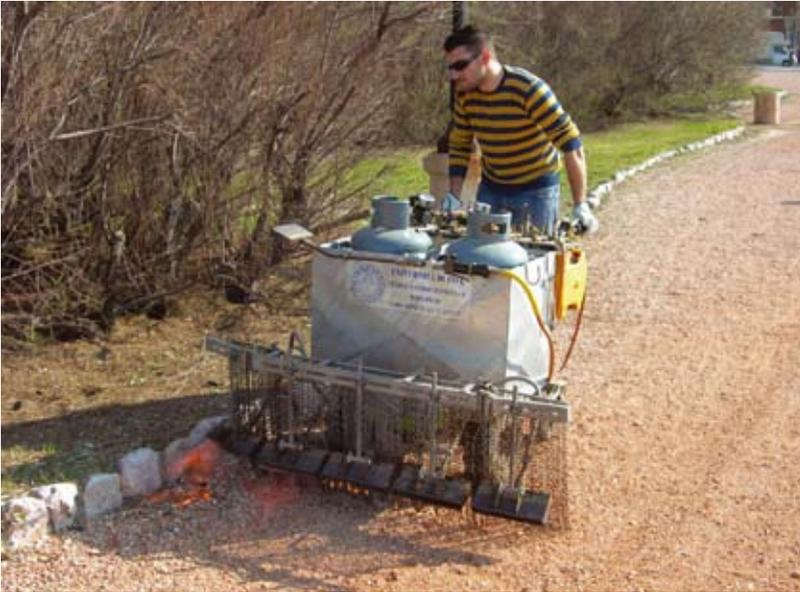
**Fig. 5.8** Operatrice semovente cariolata per il pirodiserbo utilizzata nel corso delle prove di gestione della flora spontanea su superficie dura a Livorno.
