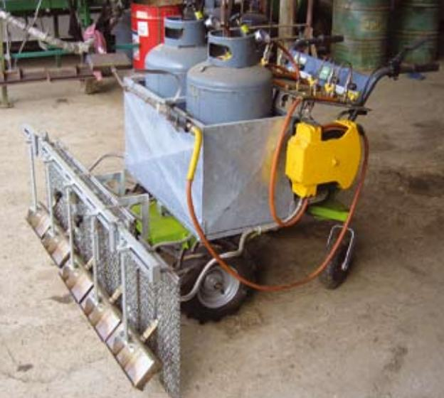
**Fig. 4.38** Attrezzatura per pirodiserbo semovente.
