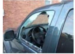
**Fig. 2.5** *L'elevato regime di rotazione della testa del decespugliatore può provocare la proiezione di materiali (piccoli sassi frammenti di vetro etc.) che possono provocare danni a persone o cose presenti nelle vicinanze del cantiere, un classico esempio e la rottura dei cristalli delle macchine parcheggiate.*
