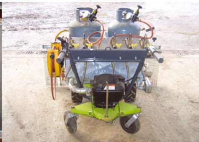
**Fig. 4.44** Operatrice dotata di motore ausiliario per la trazione con ruota piroettante anteriore
