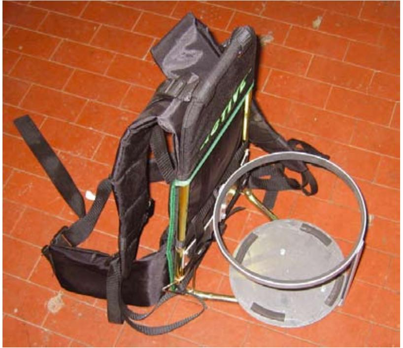
4.34). La massa dello zaino è pari a 3,5 kg e quello complessiva del serbatoio è pari 11 kg (di cui 6 kg di tara dei serbatoi standard commerciali).
