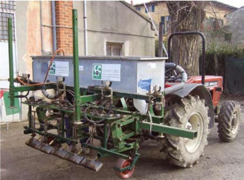
**Fig. 4.12** Operatrice portata per il pirodiserbo, progettata e realizzata presso l'Università di Pisa, accoppiata ad una trattrice di bassa potenza.
