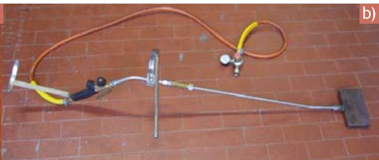
Queste attrezzature manuali sono state equipaggiate con bruciatori larghi 10 e 15 cm, a seconda delle esigenze, con una valvola di regolazione della pressione ed un manometro e con un'impugnatura dotata di rubinetti di massimo e minimo e di un grilletto per regolare la quantità di gas in uscita.
