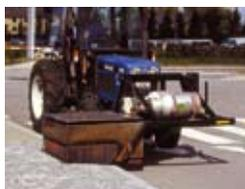
**Fig. 4.8** *Attrezzatura per il pirodiserbo accoppiata frontalmente alla trattrice e dotata di adeguata copertura per operare nel punto di raccordo tra strada e marciapiede, in fase di lavoro in Danimarca.*
