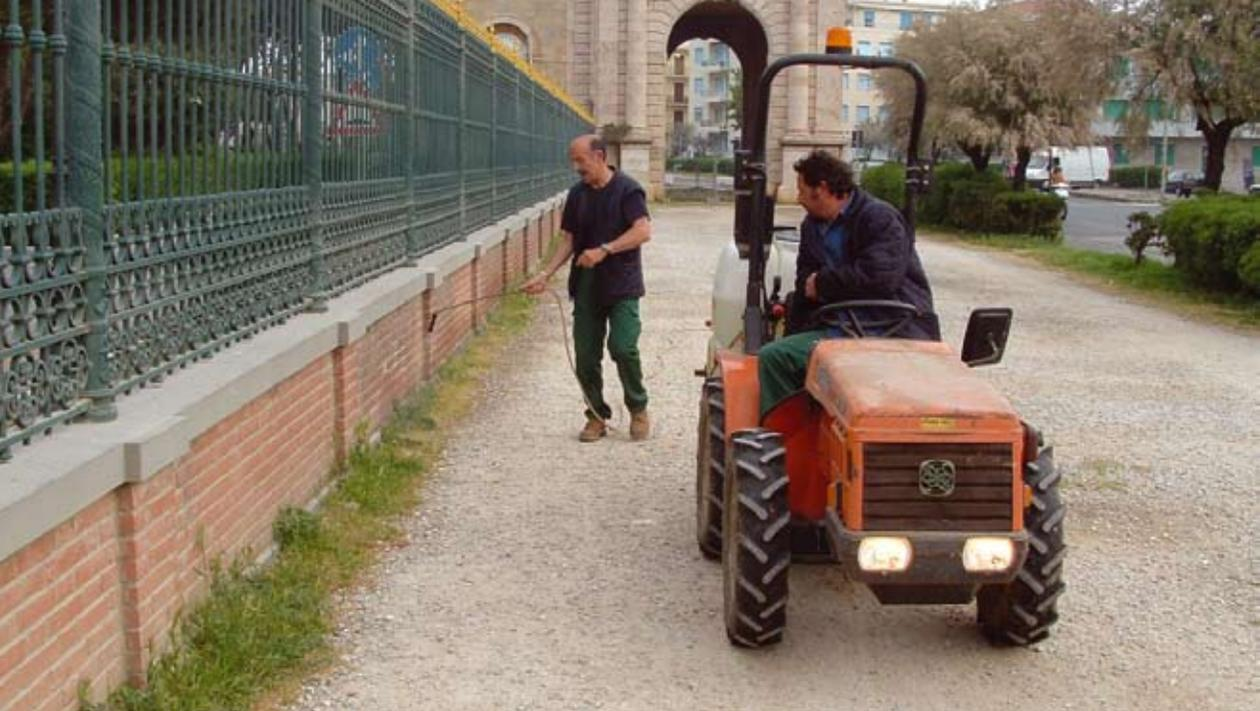
**Fig. 5.4** La distribuzione del diserbante chimico di sintesi è stata effettuata con un irroratrice portata dotata di una lancia manuale.
