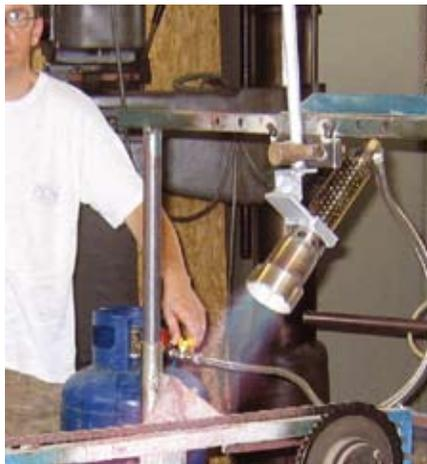
**Fig. 4.17** Attrezzatura carrellata equipaggiata con bruciatore a pentola in fase di lavoro presso l'orto botanico di Copenaghen.
