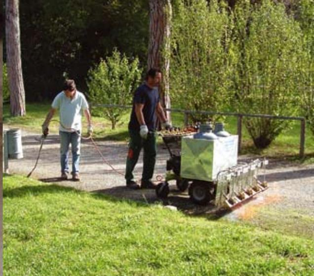
**Fig. 4.40** Operatrice per pirodiserbo con bruciatori regolati per trattamenti laterali: a) particolare b) macchina in lavoro.
