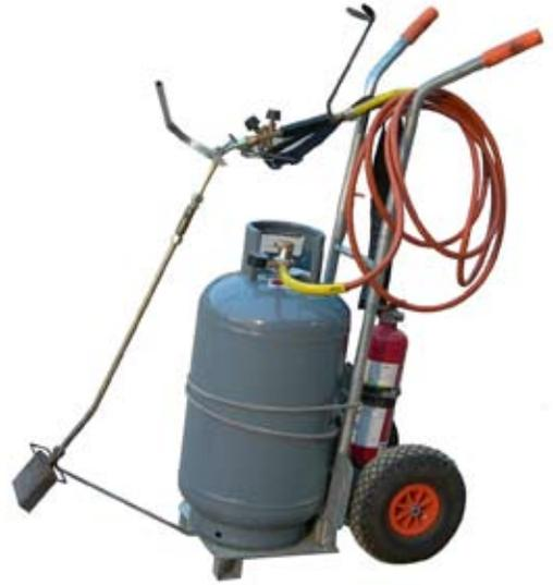
**Fig. 4.36** Attrezzatura carrellata con lancia manuale
