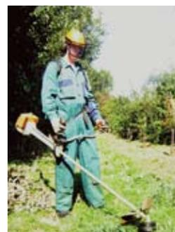
**Fig. 2.2** *Il decespugliatore sono utilizzati per le rifiniture e per il taglio delle piante infestanti su superficie dura.*
