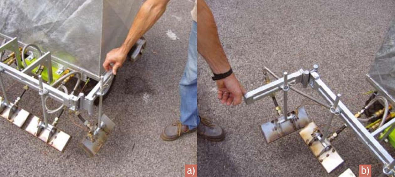
**Fig. 4.41** Funzionamento delle cerniere elastiche sul telaio porta bruciatori.
