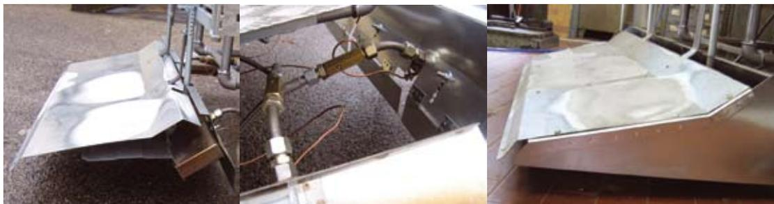
**Fig. 4.46** Particolari delle coperture dei bruciatori.
