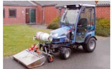
**Fig. 4.11** Attrezzature accoppiate a lawn tractor con bruciatori coperti.
