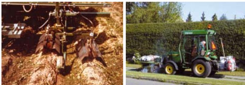
**Fig. 4.4** *Trattamento di pirodiserbo effettuato in pre-raccolta su patata.*
