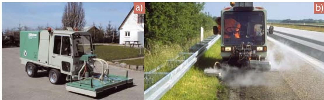
**Fig. 4.29** *Macchine a vapore per il controllo delle infestanti in fasedi lavoro in area urbana (a) e su un'autostrada (b).*
