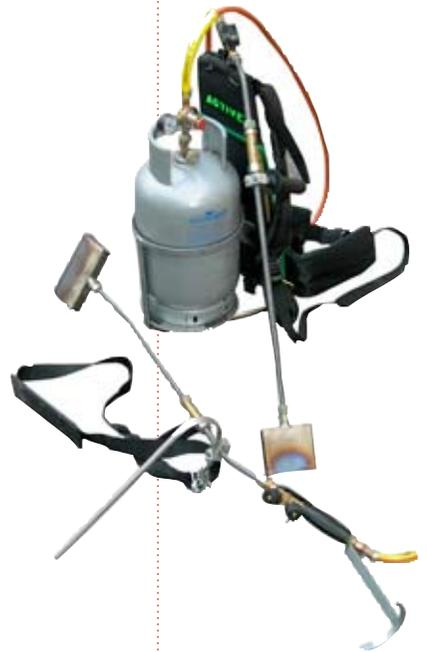
**Fig. 4.33** Attrezzatura per pirodiserbo di tipo spalleggiato
