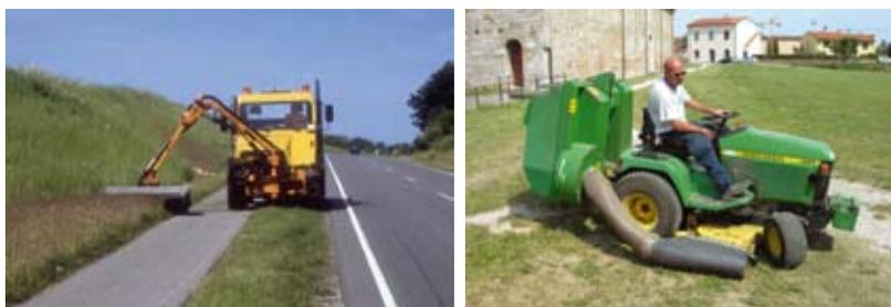
**Fig. 2.1.** *Macchine operatrici utilizzate per lo sfalcio di estese superfici inerbite: a) trinciatrice; b) trattorino rasaerba.*
