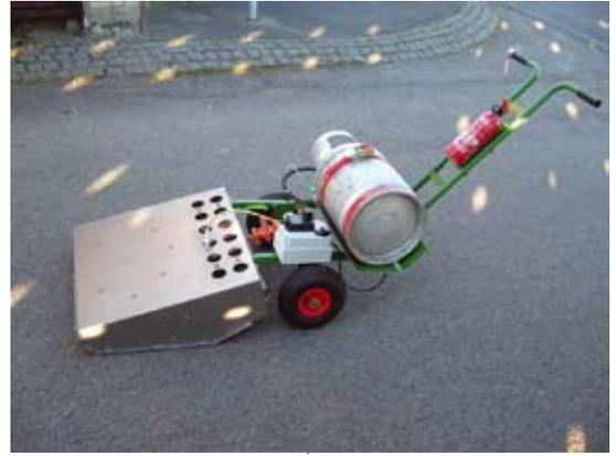
**Fig. 4.10** Attrezzature per pirodiserbo carrellate spinte dall'operatore con bruciatori coperti.
