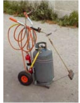
**Fig. 5.3** *Attrezzatura utilizzata per effettuare i trattamenti di pirodiserbo nel corso della sperimentazione nel Comune di Livorno.*
