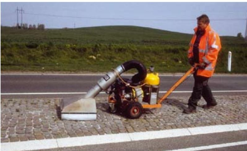
**Fig. 4.28** Macchina che produce aria calda per il controllo delle infestanti.
