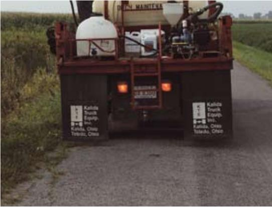
**Fig. 2.12** Distribuzione di erbicida su un margine stradale, per contenere lo sviluppo della vegetazione nel periodo primaverile-estivo.
