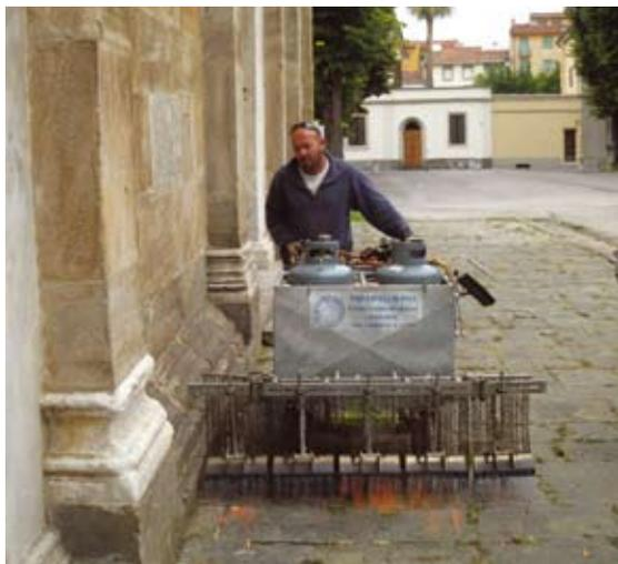
**Fig. 4.24** *L'impiego di attrezzature manuali o semoventi con operatore al seguito impone di utilizzare velocità di avanzamento ridotte (2-3 km/h al massimo) associate a basse pressioni di esercizio del GPL (in genere 0,2 MPa).*
