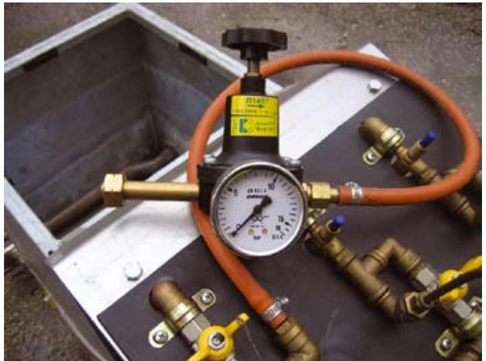
**Fig. 4.14** Quadro comandi di efflusso del GPL (a) e regolatore di pressione e manometro (b) di cui sono equipaggiate macchine complesse realizzate dal MAMA DAGA dell'Università di Pisa.
