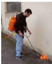
**Fig. 4.9** *Attrezzatura per pirodiserbo spalleggiata (Uliva).*
