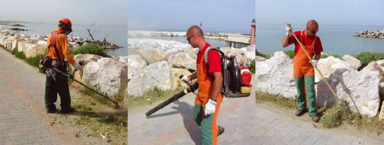
**Fig. 2.8** Sequenza di operazioni di controllo delle infestanti a mezzo di decespugliatore: **a)** sfalcio; **b)** andanatura con soffiatore motorizzato; **c)** raccolta della biomassa vegetale tagliata.
